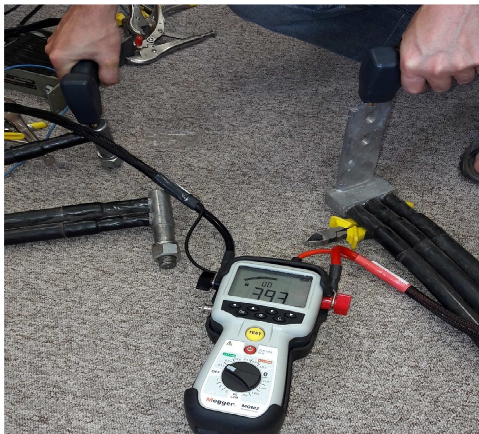
Obr. č. 3: Měření odporu přístrojem Megger MOM2 svazek 2+1*20/420
