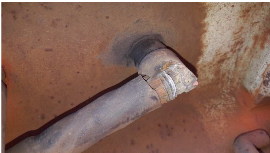
Obr. č. 8: Zlomený kolík, způsob připevnění lana do kolíku
